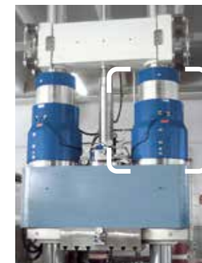
液压内高压压机 能产生400吨压紧力
