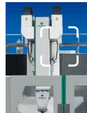
剪式升降台 锁定线性驱动的Z轴运动
