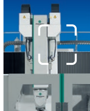
Máquina herramienta Para asegurar el eje Z con accionamiento lineal
