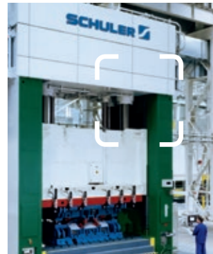
Prensa hidráulica Dispositivo anticaída homologado como dispositivo de retención por la DGUV
