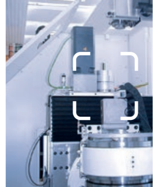
Rectificadora Para asegurar el eje Z en caso de parada de emergencia y en trabajos de mantenimiento
