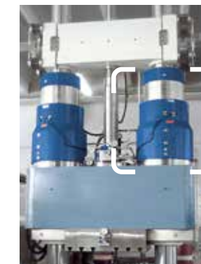
Hydraulinen sisäsuurpainepuristin 400 tonnin sulkuvoiman luonti
