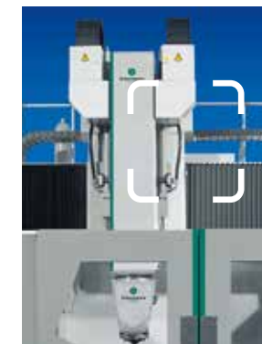
Työstökone Z-akselin varmistus lineaarikäytöllä
